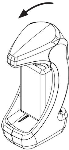
Drücken Sie die Auslaufblende an der Vorderseite nach unten und vergewissern Sie sich, dass sie ordnungsgemäß geschlossen ist (hinten und seitlich prüfen).
