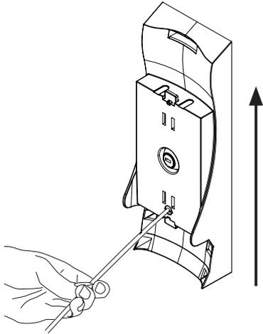
Um den Wandhalter von der Wandplatte zu entfernen, führen Sie ein spitzes Werkzeug in die vorgesehene Bohrung und drücken Sie die Federzunge der Wandplatte nach hinten. Der Wandhalter kann nun nach oben herausgeschoben werden.
