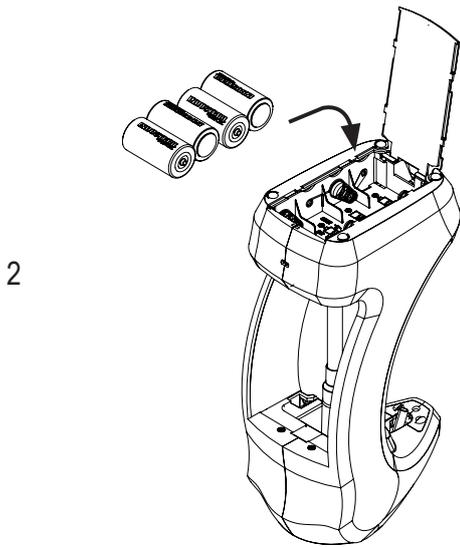
Legen Sie die Batterien gemäß den Markierungen im Batteriefach ein. Achten Sie auf richtige Polarität. Platzieren Sie das Band unter den Batterien, bevor Sie diese einlegen.
