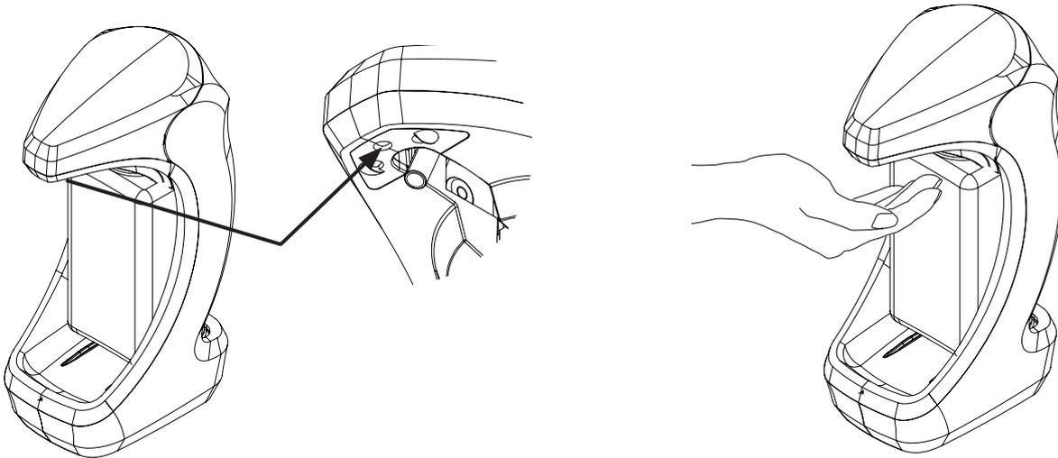
Wenn die Auslaufblende geschlossen ist, warten Sie 3 Sekunden, bis die rote LED nicht mehr leuchtet. Um den Spendermechanismus zu aktivieren, halten Sie die Hand unter die Auslaufblende (ca. 5 cm Abstand). Dadurch gibt der Spender automatisch einen Sprühstoß ab.
