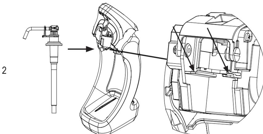
Schieben Sie die Pumpe in die Führungen des Gehäuses und rasten Sie die Sicherungslasche wie abgebildet ein.
