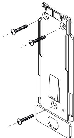
Befestigen Sie die Wandplatte mit den mitgelieferten oder entsprechend geeigneten Befestigungsmaterialien an der Wand.
