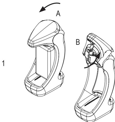
Um die Auslaufblende zu öffnen, ziehen Sie diese zunächst nach vorn (A) und schwenken sie anschließend nach oben in Richtung der Rückseite des Spenders (B).
