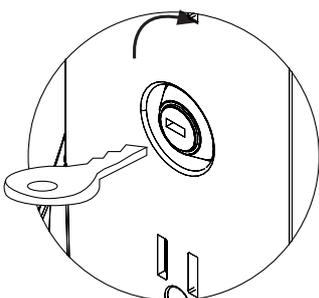
Drehen Sie den Schlüssel im Uhrzeigersinn, um den Spender zu verriegeln. Entfernen Sie den Schlüssel, bevor Sie den Behälter installieren.
