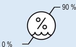
Achten Sie darauf, dass das Gerät nur bei einer relativen Luftfeuchtigkeit von <90% (nicht kondensierend) benutzt wird.
