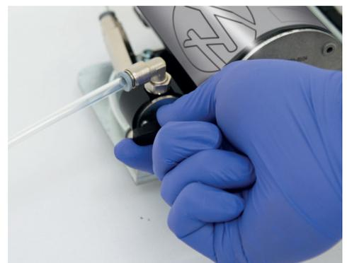
10 Wassereingangsschlauch der Dentaleinheit vom BR System trennen.
