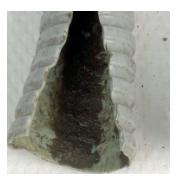
**Biofilm** dans le tuyau d'aspiration
