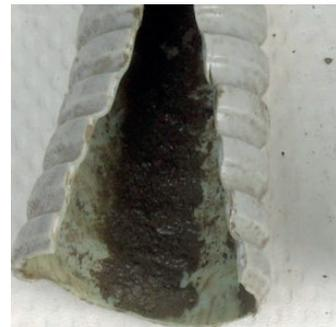
**Biofilm nel tubo del sistema di aspirazione**
