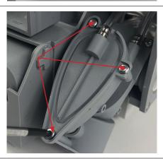
Verschlussmittelteil demontieren (2x Schrauben lösen)
